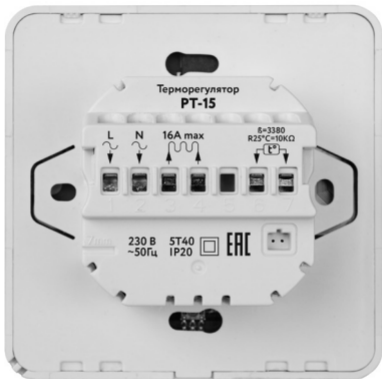
Рис. 2 Вид сзади терморегулятора PT-15
